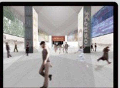
改札口の既存の状態はやたらと長い直線のアプローチは無駄な動線と言える。改札から外にあるGLから2500mm分の壁を撤去し、シャッター化か幅広のドアを日常開放することによってデッキと一体となった広い駅前空間が生まれる。
